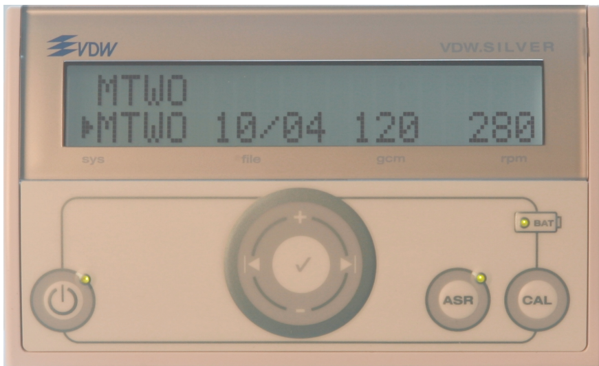
Fabrieksinstelling voor Mtwo-vijl 10/.04 op het frontpaneel.
