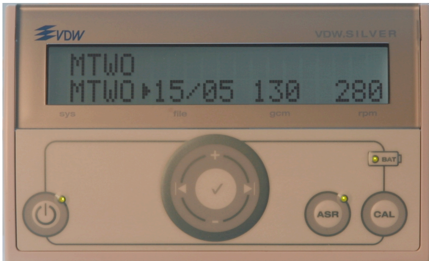
Fabrieksinstelling voor MTwo 15/.05 op het frontpaneel.
