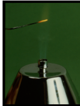
In een gasvlam wordt het modelleerinstrument verhit
